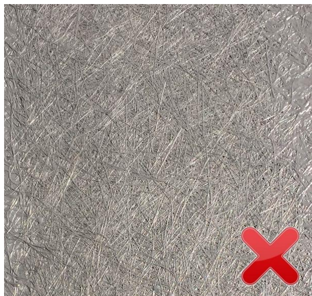
Es wurde zu wenig Harz für die erste Schicht aufgetragen, oder die Matte wurde nicht in das Harz eingedrückt. Fasern sind silbrig und gerade.
