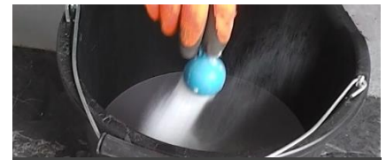
Härter wird in das Harz dosiert
